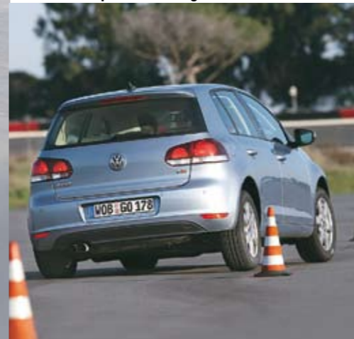
Ballet: op de slalom komt tot uiting hoe de auto reageert op lastwissels en hoe scherp de band reageert op de besturing.
